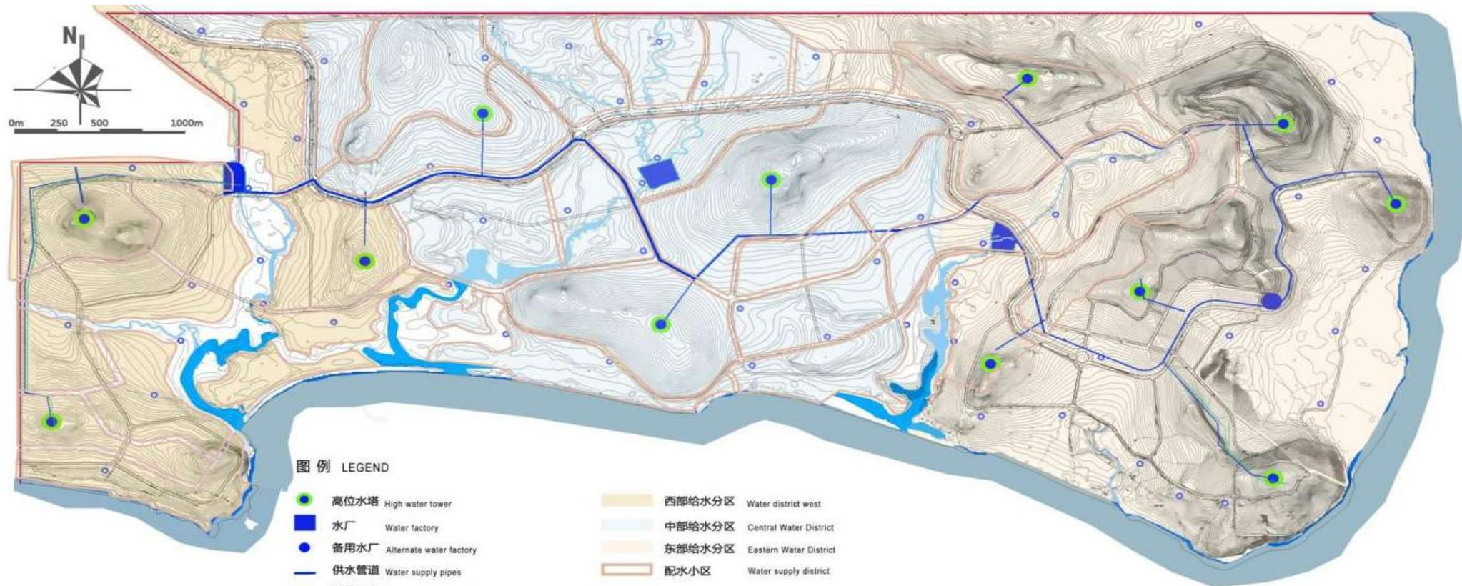
规划银湾年用水总量3000万吨，用水指标8万吨/日，最大日10万吨。其中生活用水量750万吨/年，日指标2万吨，需要由满足生活饮用卫生标准的净水设施提供。生活用水的1/4约170万吨由地下水提供，3/4由地表水供应。规划银湾划分三个给水分区，每个给水分区独立设置提供1000万吨/年左右规模的局域水厂。局域水厂设施包括地表水汇集汲取、地上及地下水蓄水，生活饮用水净化处理、高位水塔群及加压设施，以及深凿大口径井群水源场。规划银湾深井总数50孔，群井间距原则上不小于200米。
